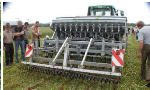
Slika 16: Sejavnica in primer direktne setve brez oranja. Vir: Ivan Brodnjak
