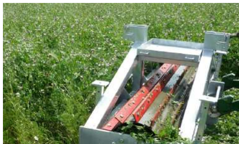
Slika 15: Rezalni mulčer za obdelavo ozelenjene površine za izvedbo direktne setve v mulč. Vir: Ivan Brodnjak
